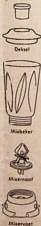
fig. 1: Schematische voorstelling van een mixer zoals hij op de keukenmotor kan worden gemonteerd.
